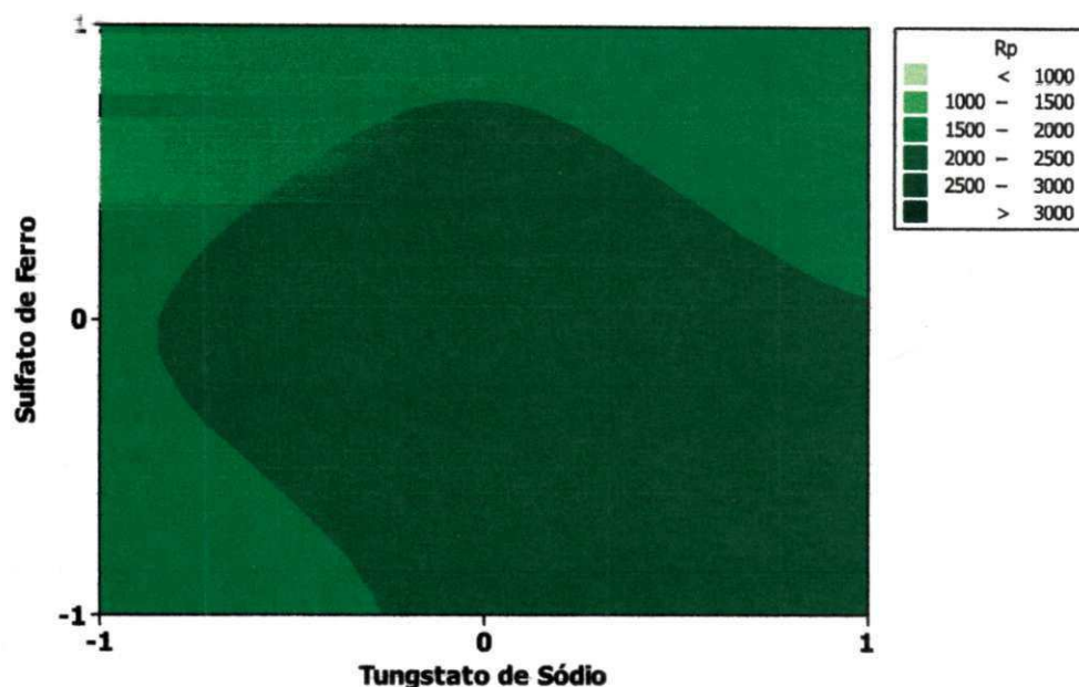
Figura 10.b: Superfície de contorno da liga NiFeW para a resistência à corrosão em função das concentrações de sulfato de ferro e tungstato de sódio
