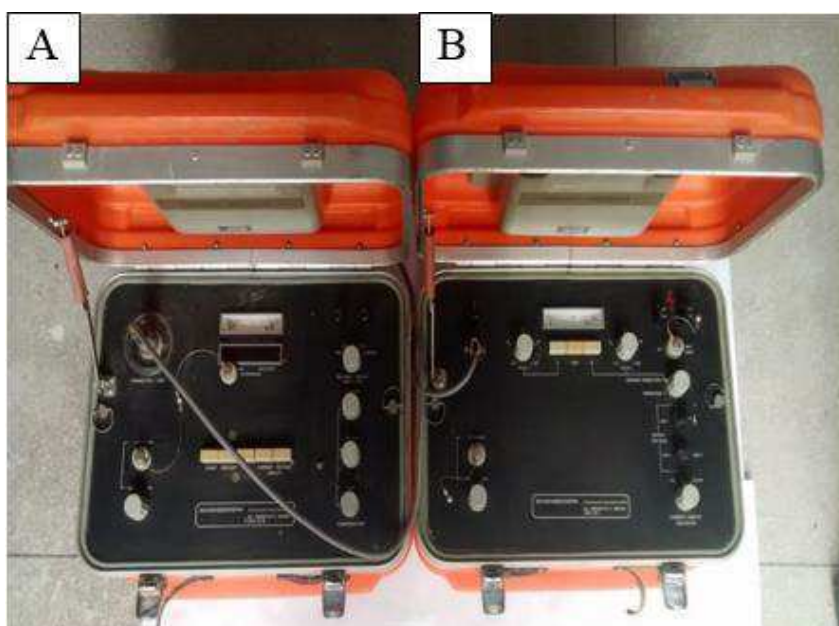
Figura 66: (A) Módulo de leitura de diferencial de potencial e (B) Módulo de injeção de corrente
