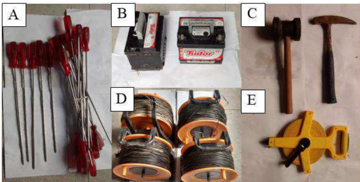
Figura 65: Acessórios utilizados no levantamento de dados. (A) Eletrodos; (B) Baterias; (C) Martelos; (D) Carretéis; (E) Trena.
