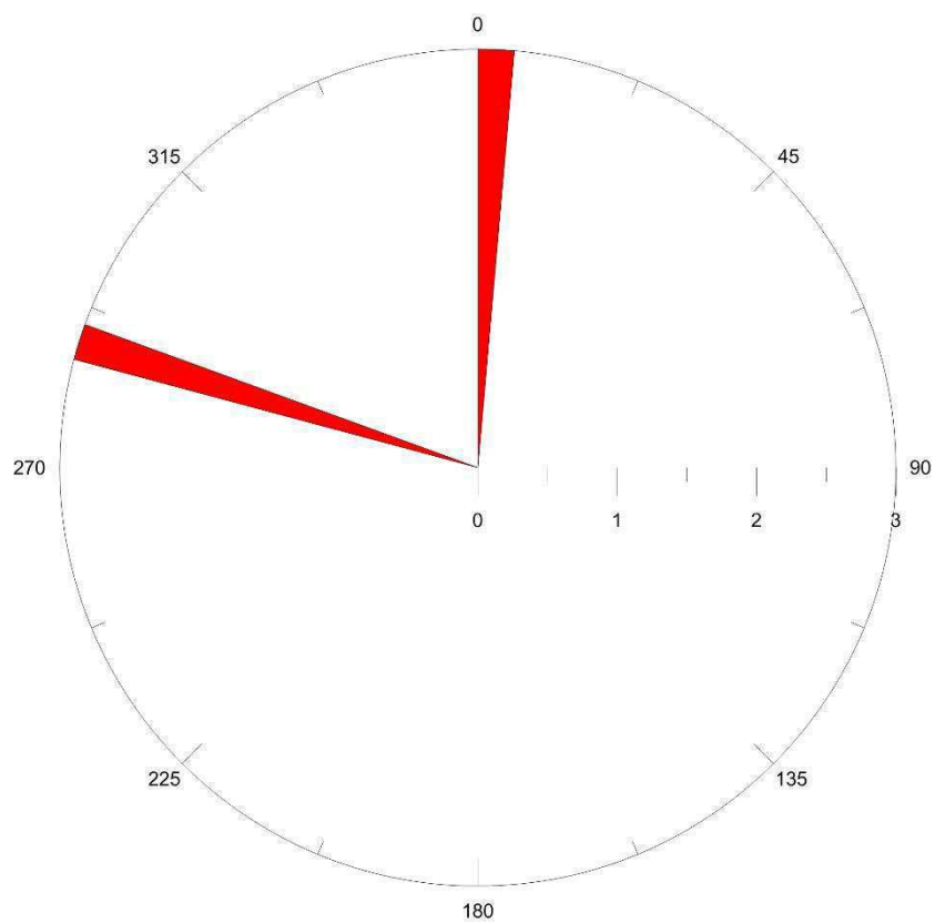
Figura 54: Direção das fraturas observada em afloramento no ponto 6 no Sítio Macaco.
