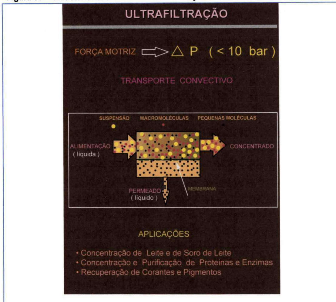
Figura 06 – Características Básicas da Ultrafiltração
