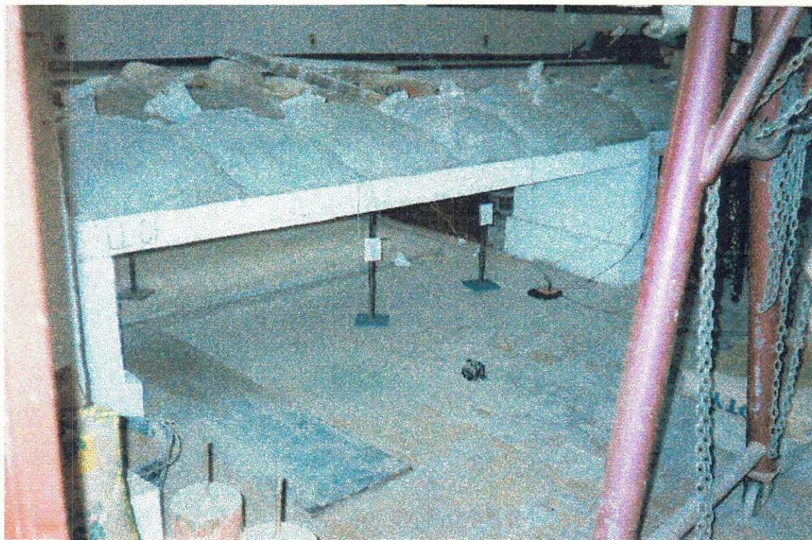
Fotografia 10 - Laje Pré-Moldada Submetida a Carregamento ao Longo do Tempo
