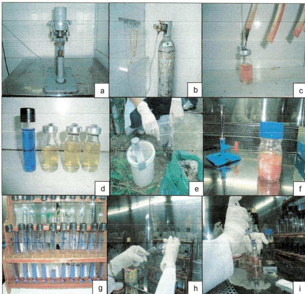
Figura 14: (a) Máquina usada para lacrar os tubos de penicilina; (b) Tubo de nitrogênio; (c) Nitrogênio sendo purgado no tubo de penicilina; (d) Tampão redutor (esquerda) e tubos com meio tioglicolato (direita); (e) Coleta e armazenamento das amostras para anaeróbios; (f) Tubos contendo as diferentes diluições; (g) e (h) Inoculação da amostra nos tubos de penicilina.
