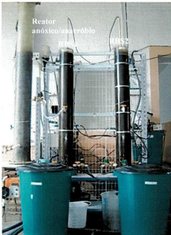
**Figura 2.6** – RBS1 (à esquerda) e RBS2 (à direita).
