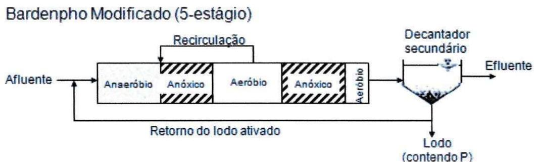
**Figura 1.5** - Sistema Bardenpho modificado (5 estágios). **Fonte:** Adaptado de Metcalf e Eddy (2003).
