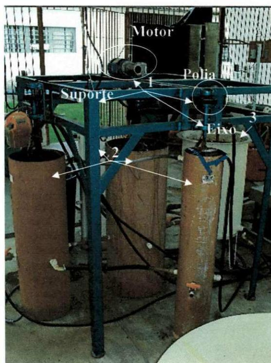
**Figura 2.1** - Esquema de montagem dos reatores, decantador e sistema de agitação.
