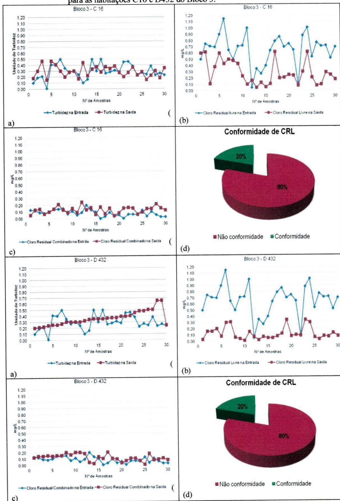
Figura 4.19 – Resultados de turbidez (a), CRL (b), CRC (c) e conformidade do CRL (d) para as habitações C16 e D432 do Bloco 3.
