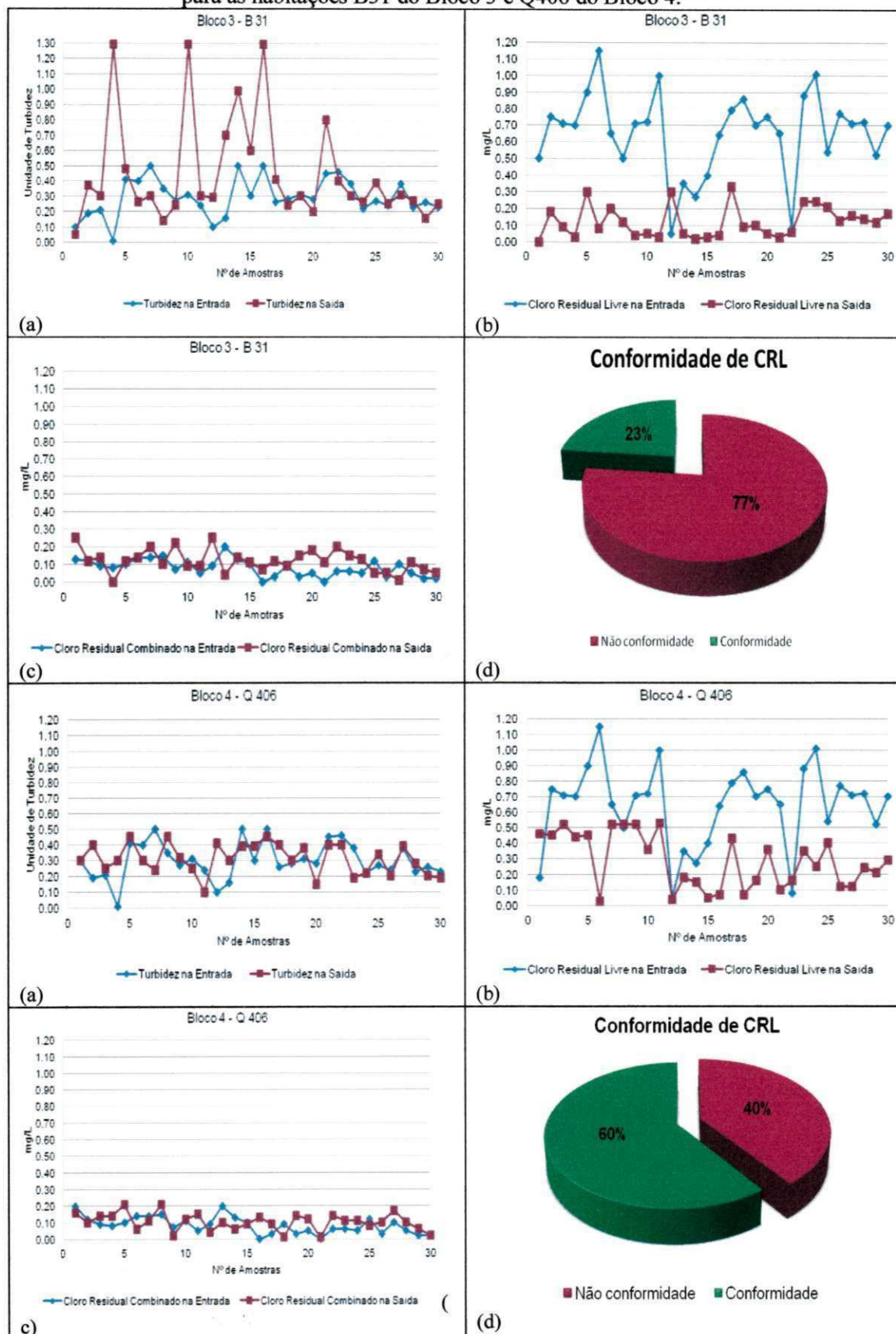
Figura 4.20 - Resultados de turbidez (a), CRL (b), CRC (c) e conformidade do CRL (d) para as habitações B31 do Bloco 3 e Q406 do Bloco 4.
