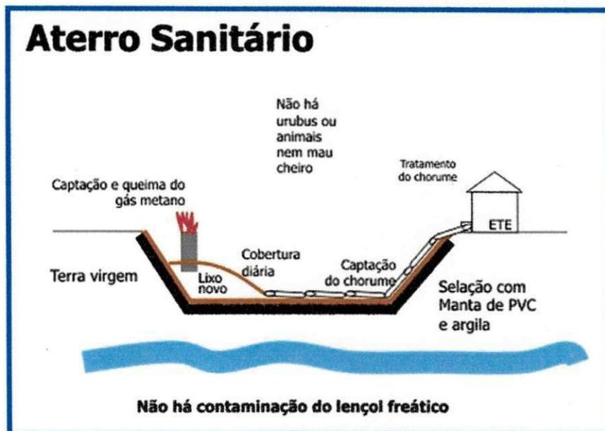
**Figura 11: Estrutura de um aterro Sanitário - Fonte:(ALVES,2010)**
