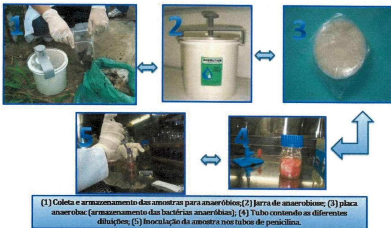
**Figura 47: Ensaio para Anaeróbios Totais (GGA).**
