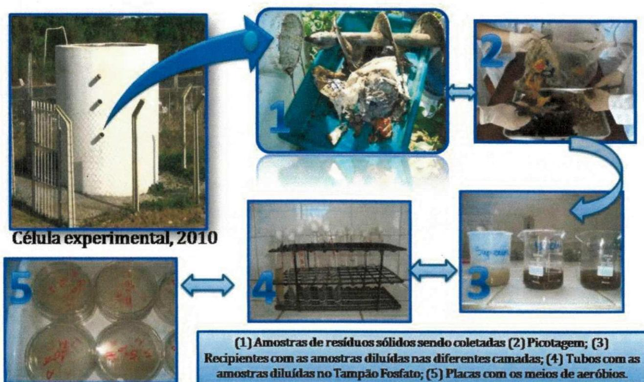
Figura 46: Ensaio para Aeróbios Totais (GGA).
