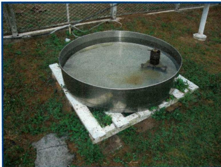
**Figura 53: Tanque Evaporimétrico Classe A (EMBRAPA,2011).**
