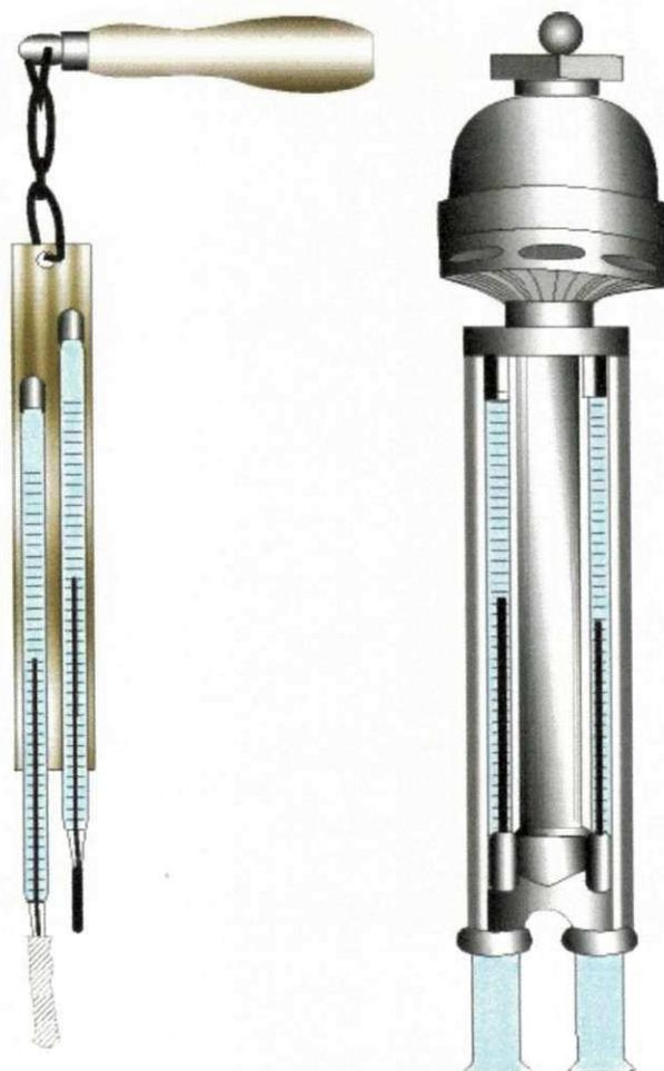
**Figura 19: Psicrômetro de funda(esquerda); psicrômetro Assmann(direita)
