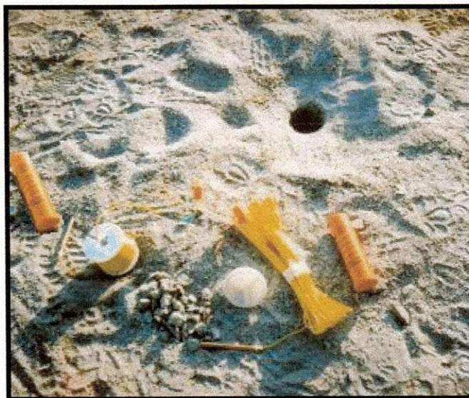
Figura 5.12 - Acessórios usados no carregamento de cada mina (2002).
