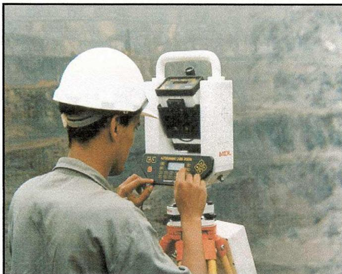
Figura 4.1 - Operação de perfilagem das bancadas (NOJIRI *et al.*, 2002).
