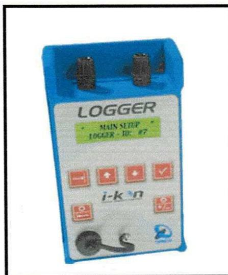
Figura 5.2 - Programador Logger (ORICA, 2002).
