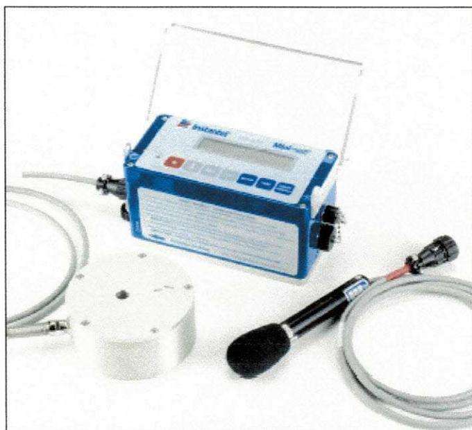
Figura 4.5 - Sismógrafo de engenharia.
