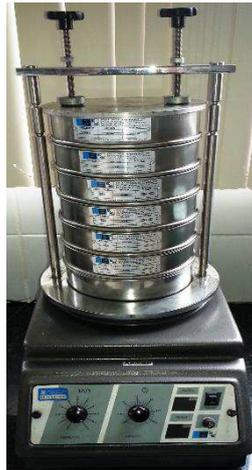
Figura II.5 – Agitador eletromagnético (O AUTOR, 2014)
