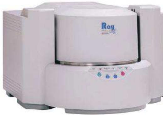
Figura II.10 – Espectrômetro de fluorescência de raios X por energia dispersiva (O AUTOR, 2014)
