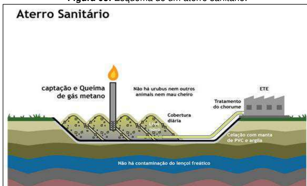
Figura 03: Esquema de um aterro sanitário.
