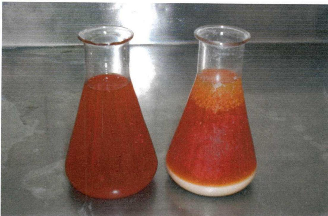
**Figura 13 - (da esquerda para direita) Amostra do licor cáustico e amostra do material a ser classificado**
