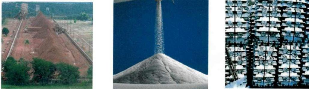
**Figura 1 - (da esquerda para direita) Bauxita, Alumina, Lingotes de alumínio**
