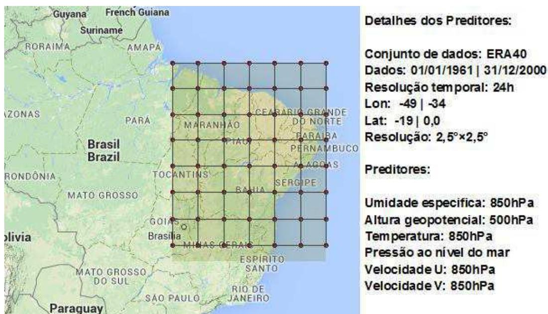
**Figura 4:** Grade e preditores utilizados para a precipitação da região Nordeste.
