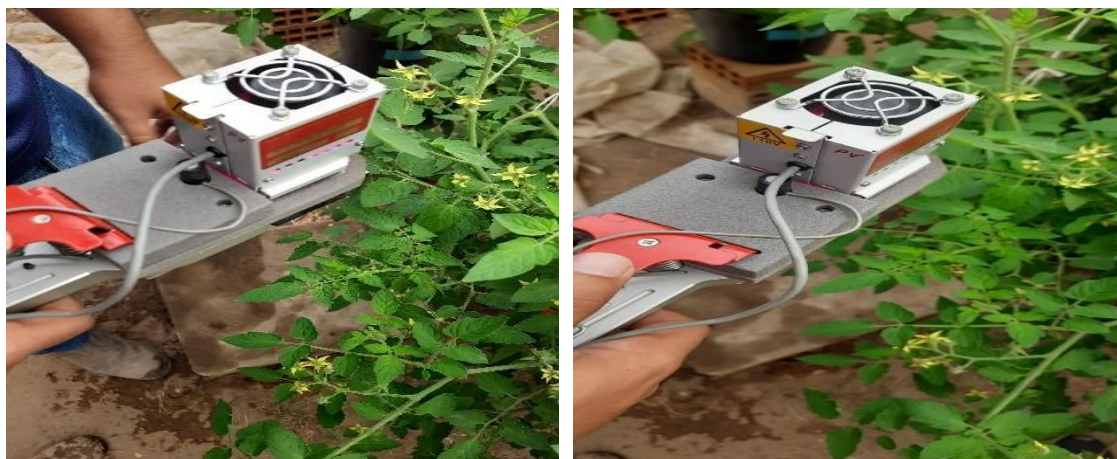
Figura 5. Equipamento portátil de medição de fotossíntese “LCPro+” da ADC Bio Scientific Ltda utilizado nas leituras das variáveis de trocas gasosas em plantas de tomate-cereja ‘Laranja’.
