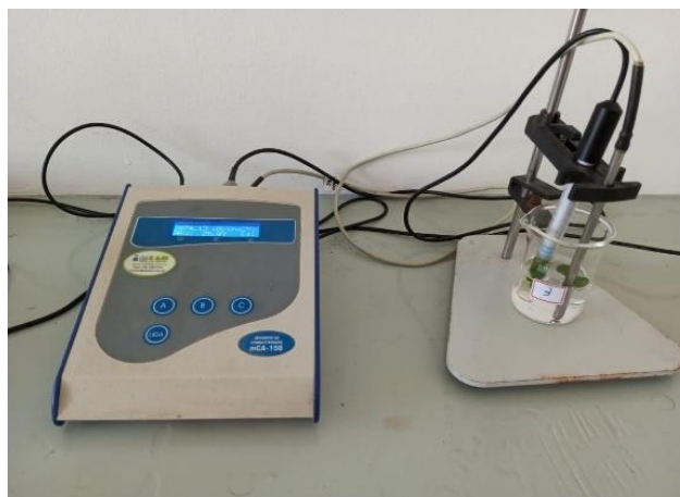
Figura 9. Amostras foliares para determinação da condutividade elétrica inicial (A); amostras em estufa (B); e demonstração de leitura da condutividade elétrica final utilizando um condutivímetro de bancada (C).
