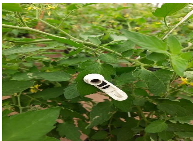
Figura 6. Utilização de clipe para leitura da fluorescência da clorofila a em plantas de tomate-cereja ‘Laranja’.
