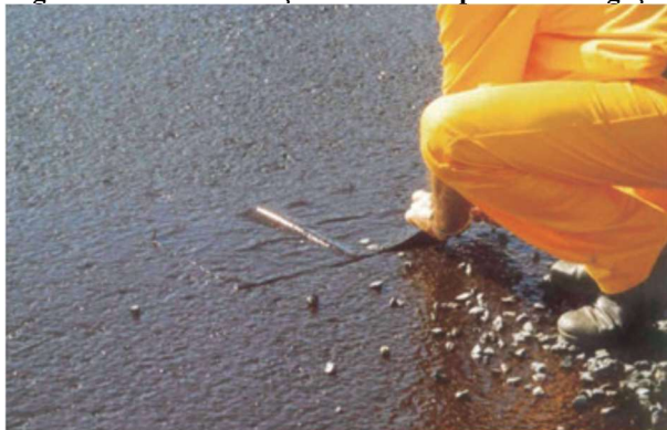
Figura 2.6 - Determinação da taxa de pintura de ligação
