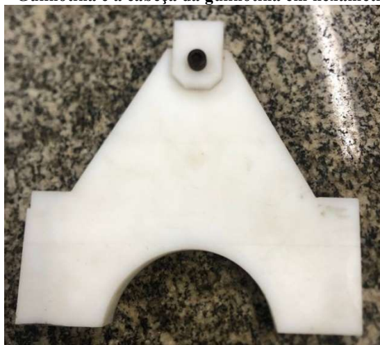
Figura 2.26 - Guilhotina e a cabeça da guilhotina em hexametilenodiamina
