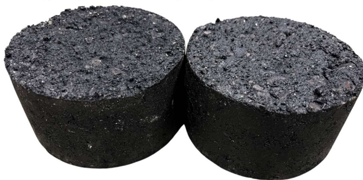
Figura 3.19 - Corpo de prova exibindo ruptura por cisalhamento na interface
