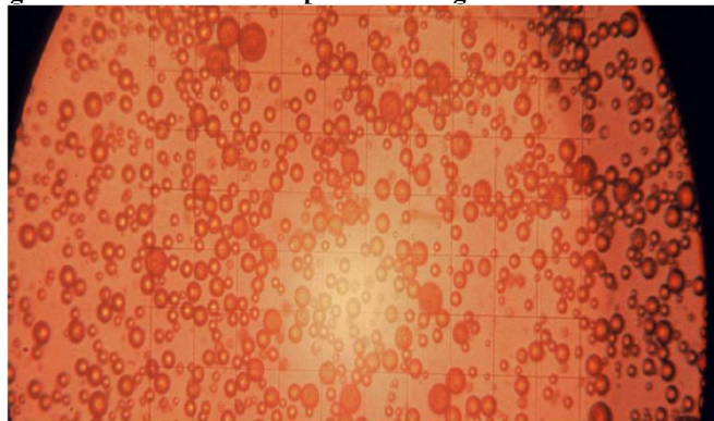
Figura 2.3 - Vista microscópica de uma gota de emulsão asfáltica
