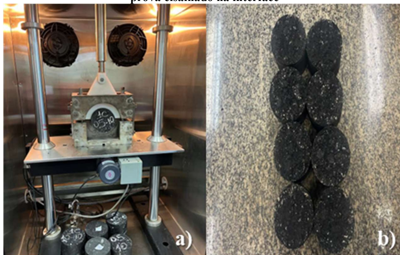
Figura 3.18 - (a) Ensaio do Leutner com temperatura controlada/amostras condicionadas (b) corpos de prova cisalhado na interface
