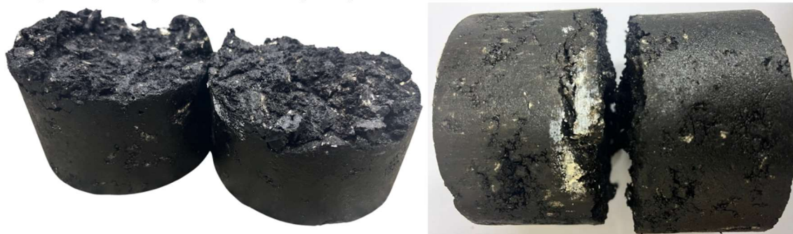
Figura 3.20 - Corpo de prova com ruptura por cisalhamento fora da interface das camadas asfálticas
