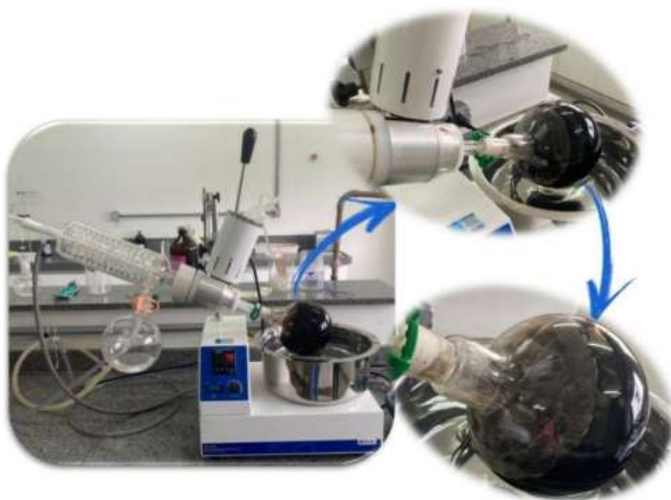
Figura 8 - Processo de recuperação dos ligantes asfálticos no rotaevaporador.
