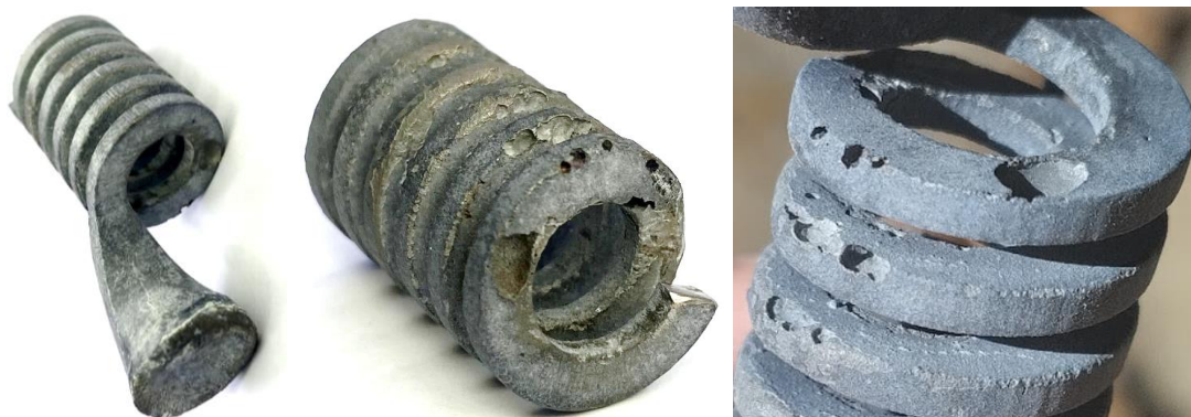
Figura 42: Mola fabricada com defeitos provocados por bolhas de gás.
