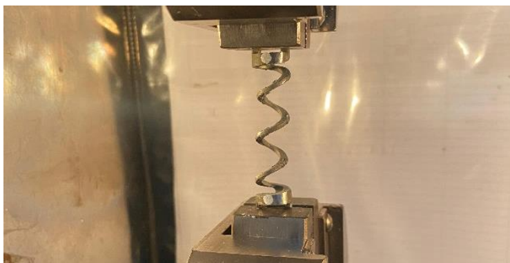
Figura 62: Mola de aço inox 304 após o ensaio.
