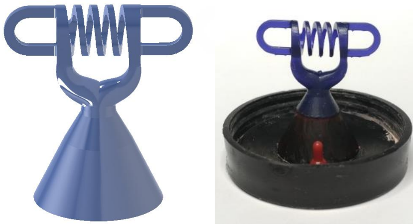
Figura 25: Canais de alimentação de mola desenhado no Autodesk Inventor (esquerda) e montagem real do modelo em resina (direita).
