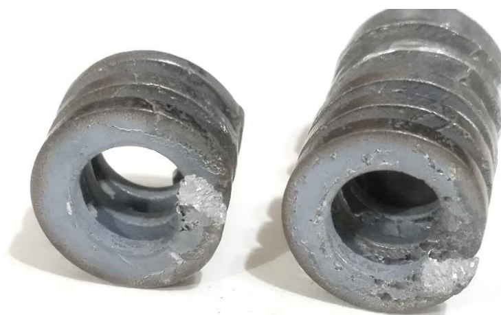
Figura 38: Detalhes da mola fraturada no ensaio de tração.
