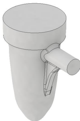
Figura 24: Cadinho desenhado no Autodesk Inventor.
