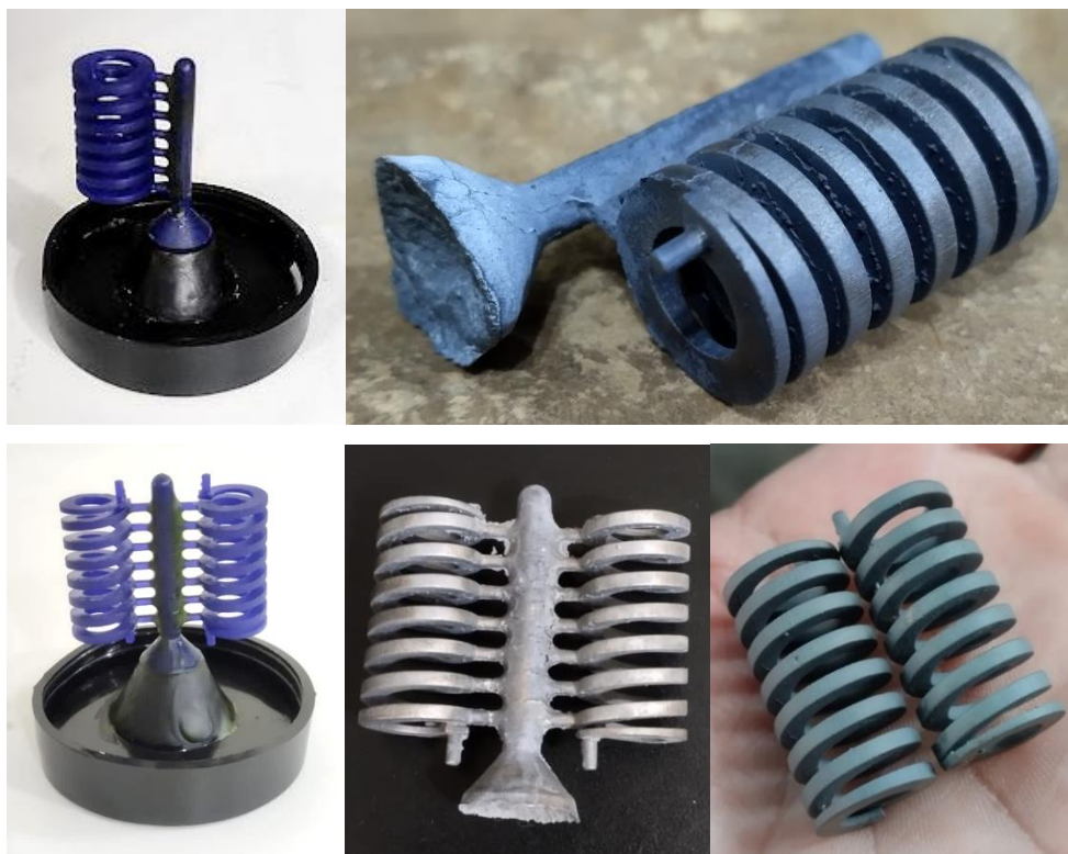
Figura 37: Modelo em resina (esq.) e mola fabricada com os canais (dir.).
