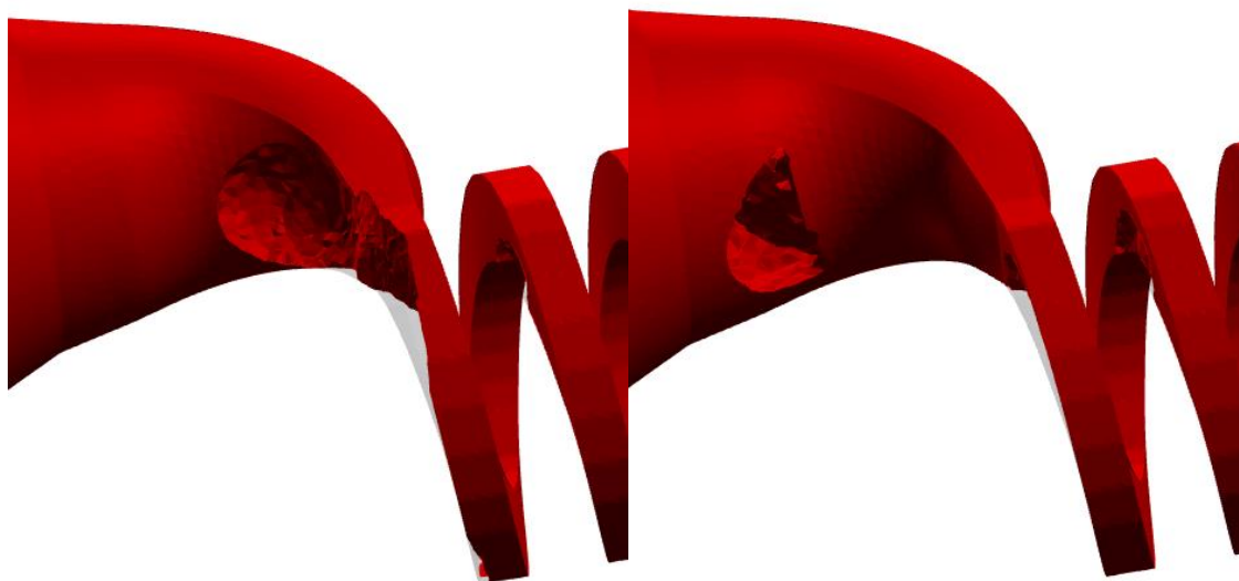
Figura 41: Detalhe de uma bolha de gás saindo do molde na simulação.
