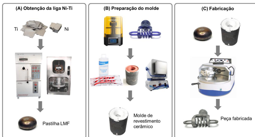
Figura 27: Etapas para a fabricação de componente LMF.
