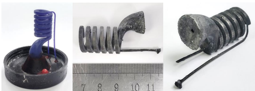
Figura 43: Canais de alimentação com a adição de vents .
