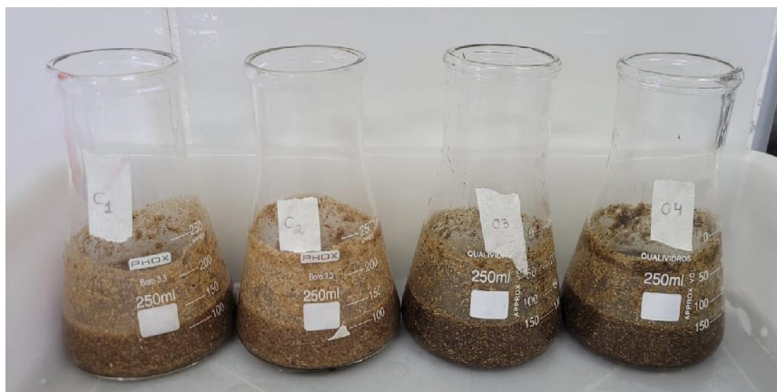
Imagem 03 – Misturas reacionais dos ensaios C1, C2, 03 e 04, antes dos testes de pré-tratamento.
