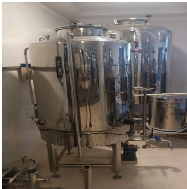
No local possui uma cisterna de 8 mil litros, onde é armazenada a água do processo de resfriamento, para que possa ser utilizada posteriormente nos banheiros e cozinha do pub, Figura 8.
