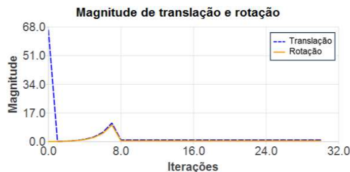
Figura 5.17: Magnitude do algoritmo Clássico ICP Ponto-a-Ponto
