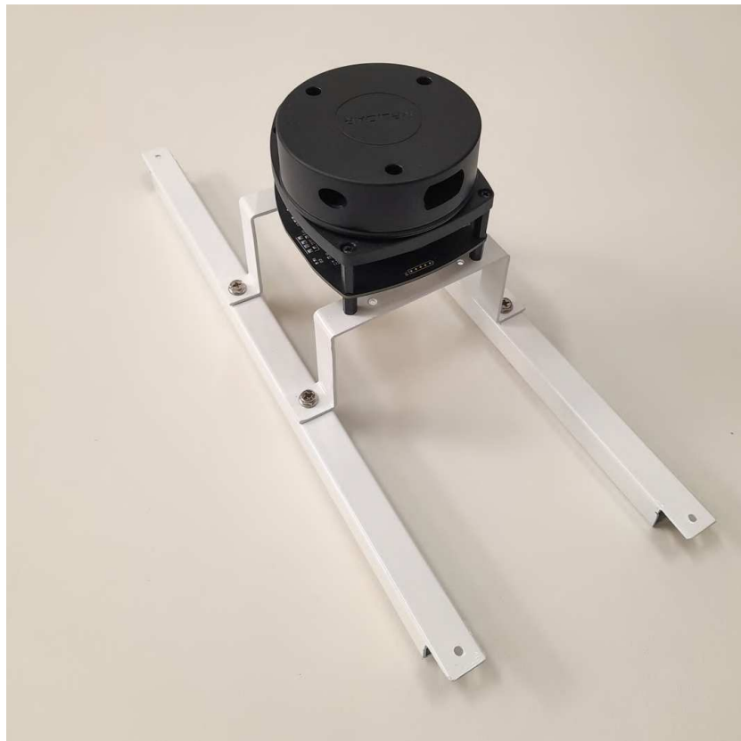
Figura 5.2: Estrutura metálica com sensor para alocar na plataforma
