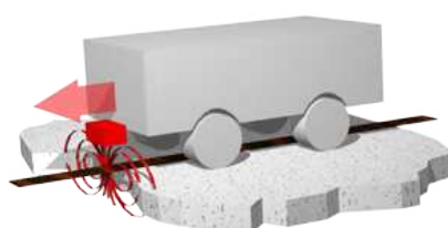
Figura 1.2: Representação do AGV com sensor guia magnético
