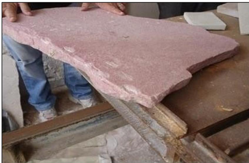
**Foto 12** – Quarteação em bancada de quartzite com serra diamantada.
