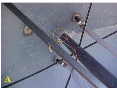
Figura 3. Detalhes dos sensores de temperatura instalados no interior do gasômetro (A) e do abrigo meteorológico (B).
