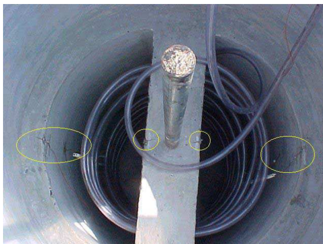
Figura 2. Posicionamento dos sensores de temperatura no interior do biodigestor.
