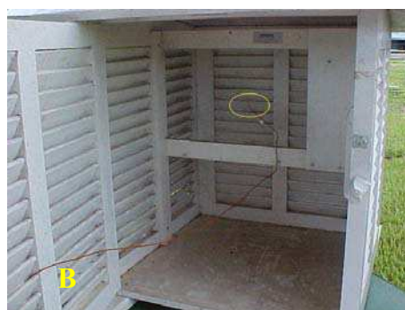
Figura 3. Detalhes dos sensores de temperatura instalados no interior do gasômetro (A) e do abrigo meteorológico (B).
