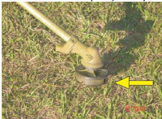
**Figura 1.** Falta de proteção do sistema de corte.
