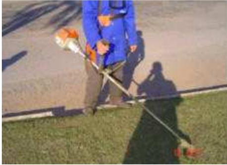
**Figura 2.** Roçadora manual motorizada em operação.
