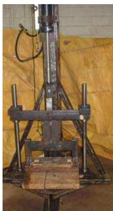
Figura 1 –Guilhotina utilizada nos ensaios de resistência ao corte das raízes de eucalipto.
