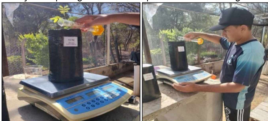
Figura 5 – Ilustração da pesagem dos sacos para controle dos regimes hídricos.
