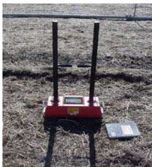
Figura 1 - Strata Gauge com duas hastes
