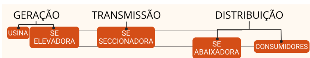
FIGURA 1- SISTEMA ELÉTRICO SIMPLIFICADO.
