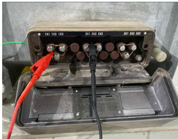
Figura 32 – Montagem para medição de R_c , bobinas 1-2
