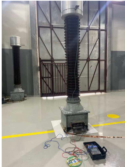
Figura 29 – Montagem para medição de R_a
