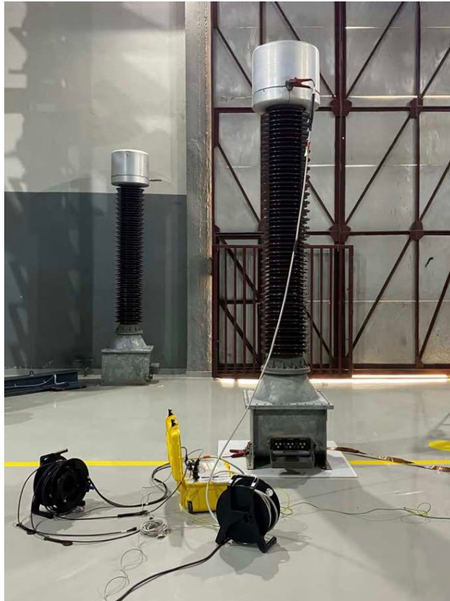
Figura 35 – Montagem para medição da tangente de perdas e capacitâncias
