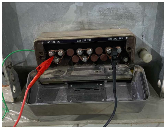
Figura 33 – Montagem para medição de R_c , bobinas 1-3
