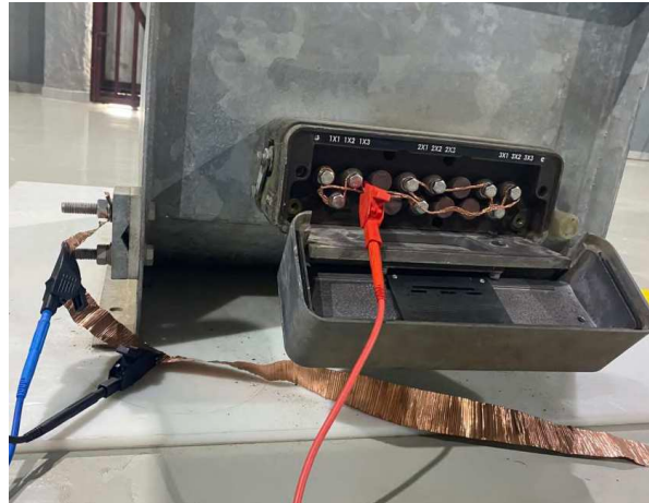
Figura 31 – Montagem para medição de R_b
