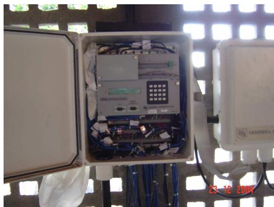
Figura 3. Equipamentos de aquisição de dados.
