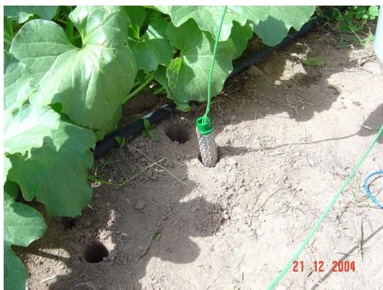
Figura 1. Instalação de sensor de umidade de solo.
