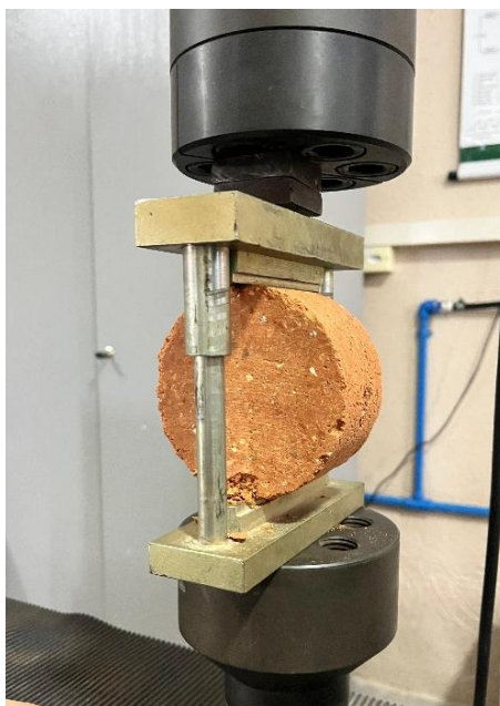
Figura 31: Aparato diametral para ensaio de RT.
