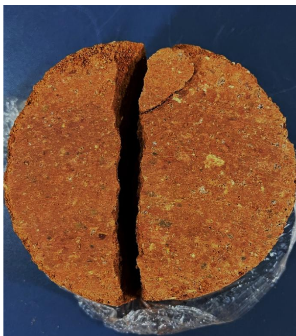
(b) Corpo de prova após ruptura.
