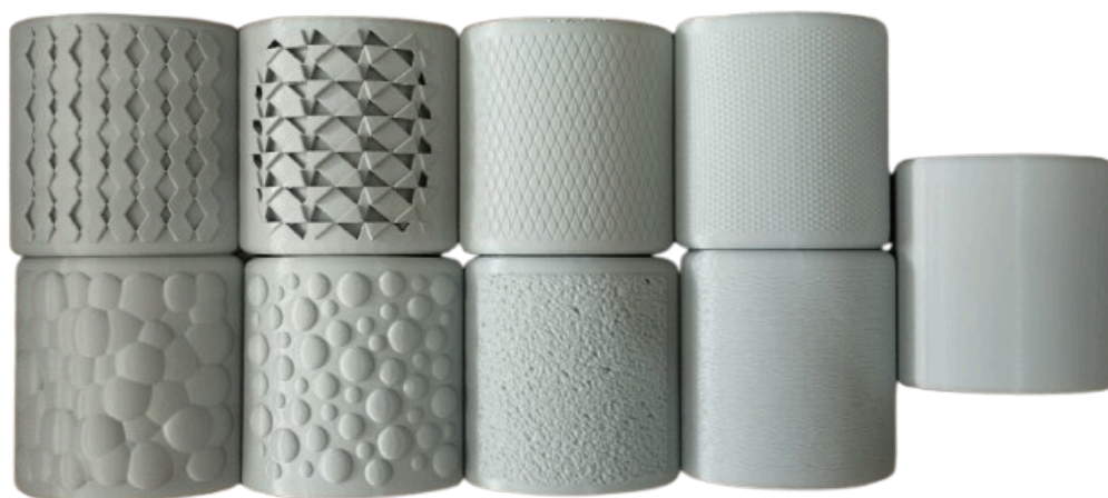
Figura 47: Protótipos das texturas impressos em PLA
