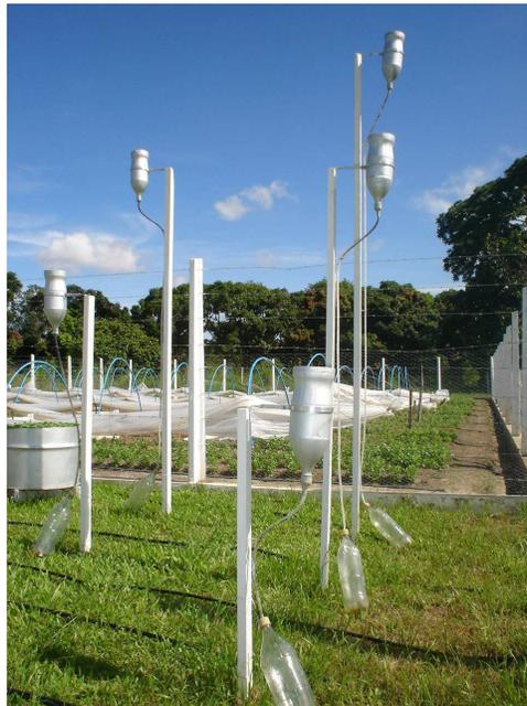
Figura 1. Vista parcial dos pluviômetros alternativos instalados sob diferentes alturas.
