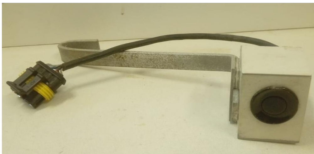
Figura 19 - Suporte e proteção contra umidade
