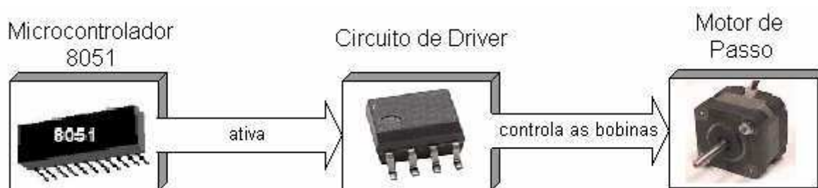
Figura 1 - Esquema de controle do motor de passo.
