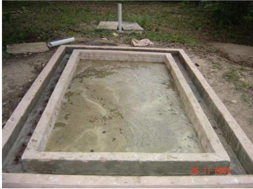
Figura 3. Vista do tanque cheio de resíduo e a canaleta Lateral com os parafusos chumbados.
