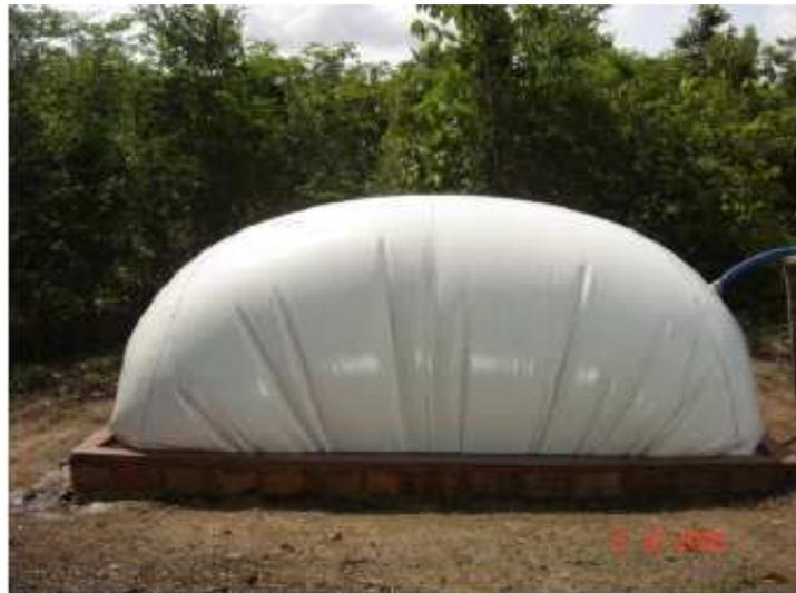
Figura 5. Vista lateral do Biodigestor inflado, com detalhe da mangueira para saída do biogás.
