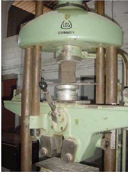
fig.1 ensaio de resistência a compressão simples
