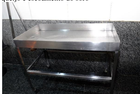
Figura 8 - Mesa em inox para descanso de queijo e escoamento do soro
