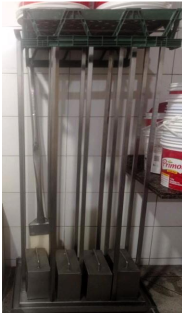
Figura 11 - Prensa em aço inox para queijo coalho
