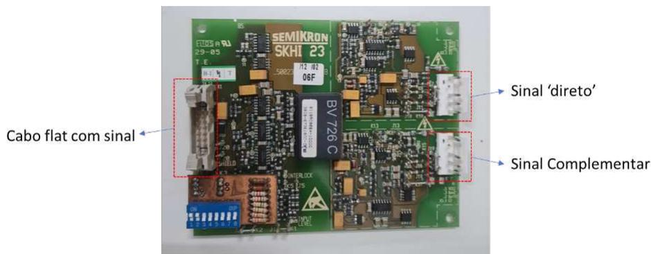
Figura 104 – Configuração dos drivers utilizados.
