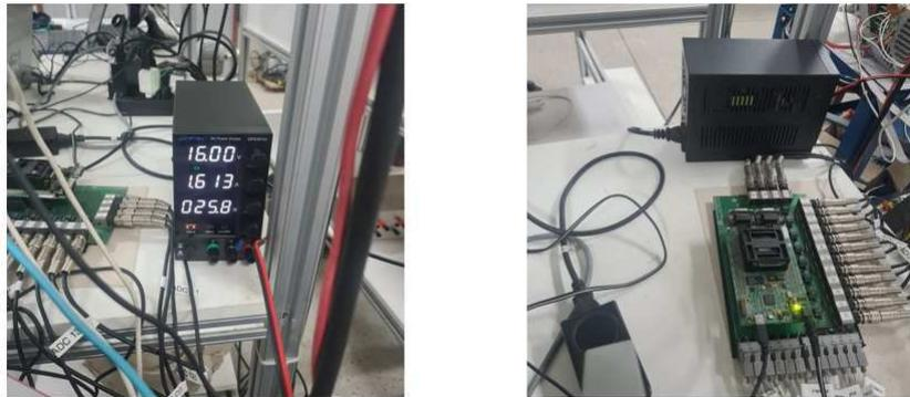
Figura 100 – Fonte inserida para alimentação dos drivers e sensores da bancada.
