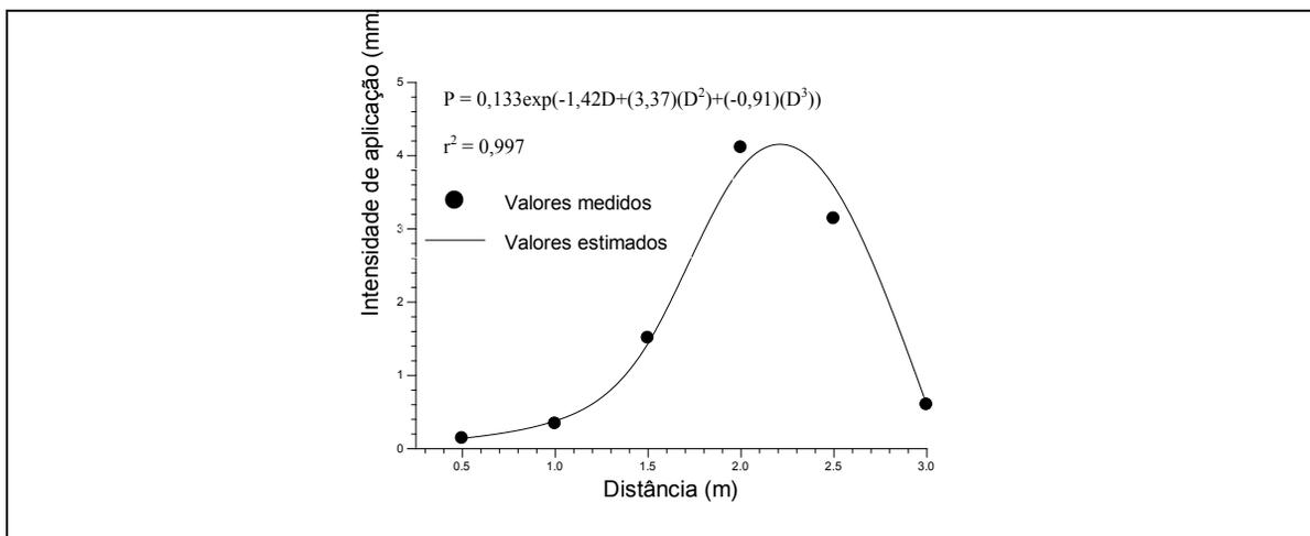
FIGURA Erro! Argumento de opção desconhecido. -Perfil de distribuição de água do microaspersor RAIN-BIRD QN-14, operando sob uma pressão de 150 kPa e velocidade de vento nulo
