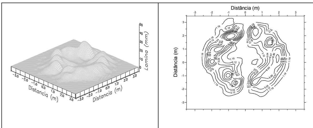
FIGURA Erro! Argumento de opção desconhecido. - Perfil tridimensional e Isoietas do microaspersor RAIN-BIRD QN-14, sob pressão de 150 kPa. em condição de laboratório.
