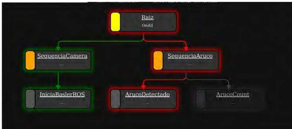
Figura 21 – Árvore de comportamento com a sequência de captura da câmera funcionando e a sequência de detecção de ArUco retornando falha.
