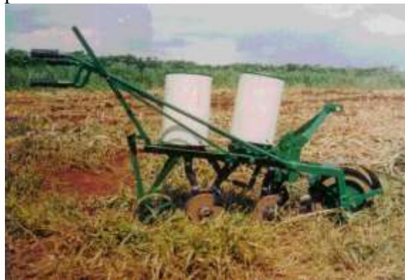
Figura 4.1.1 Semeadora-adubadora a tração animal “Gralha azul-IAPAR”
