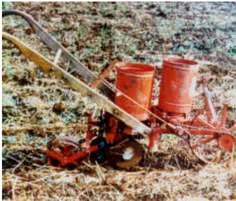
Figura 3.1.7 Semeadora-adubadora adaptada com disco duplo
