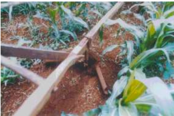
Figura 3.1.14 Cultivador a tração animal tipo chapão e acessório para aterramento
