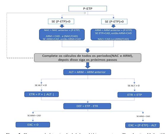
**Figura 2** - Fluxograma da determinação do balanço hídrico proposto por Thornthwaite e Mather (1995). Legenda: P é a precipitação (mm); ETP é a evapotranspiração potencial (mm); NAC é o acumulado negativo (mm); CAD é a capacidade de água disponível (mm); ALT é a alteração do ARM; DEF é a deficiência hídrica (mm); EXC é o excedente hídrico (mm). Fonte: Adaptada de Rolim et al. (2020).
