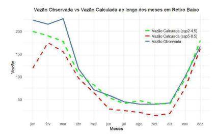
**Figura 36 -** Vazão calculada vs vazão observada ao longo do período entre 2015 a 2021 segundo a média dos modelos e de acordo com dois cenários: (a) ssp2-4.5 e (b) ssp5-8.5 em Retiro Baixo no período de validação.
