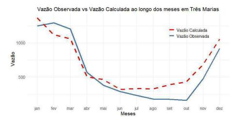
**Figura 38 -** Vazão calculada vs vazão observada entre os anos de 2008 a 2014 de acordo com o histórico dos modelos na sub-bacia de Três Marias na calibração.
