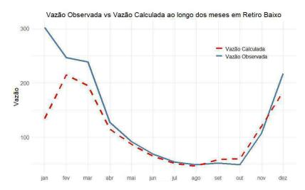
**Figura 35 -** Vazão calculada vs vazão observada entre os anos de 2008 a 2014 de acordo com o histórico dos modelos na sub-bacia de Retiro Baixo no período de calibração.
