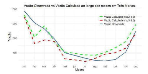
**Figura 39 -** Vazão calculada vs vazão observada ao longo do período entre 2015 a 2021 segundo a média dos modelos e de acordo com dois cenários: (a) ssp2-4.5 e (b) ssp5-8.5 em Três Marias na validação.
