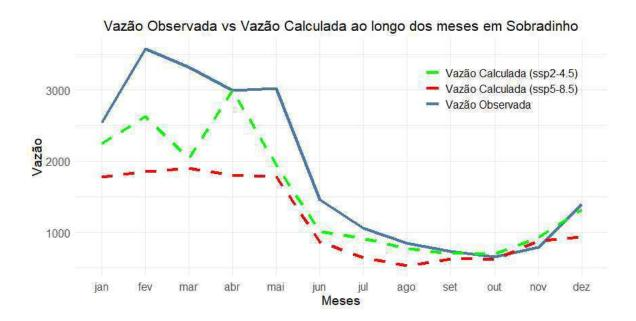
**Figura 42 -** Vazão calculada vs vazão observada ao longo do período entre 2015 a 2021 segundo a média dos modelos e de acordo com dois cenários: (a) ssp2-4.5 e (b) ssp5-8.5 em Sobradinho.
