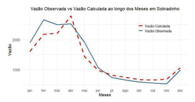
**Figura 41 -** Vazão calculada vs vazão observada entre os anos de 2008 a 2014 de acordo com o histórico dos modelos na sub-bacia de Sobradinho.
