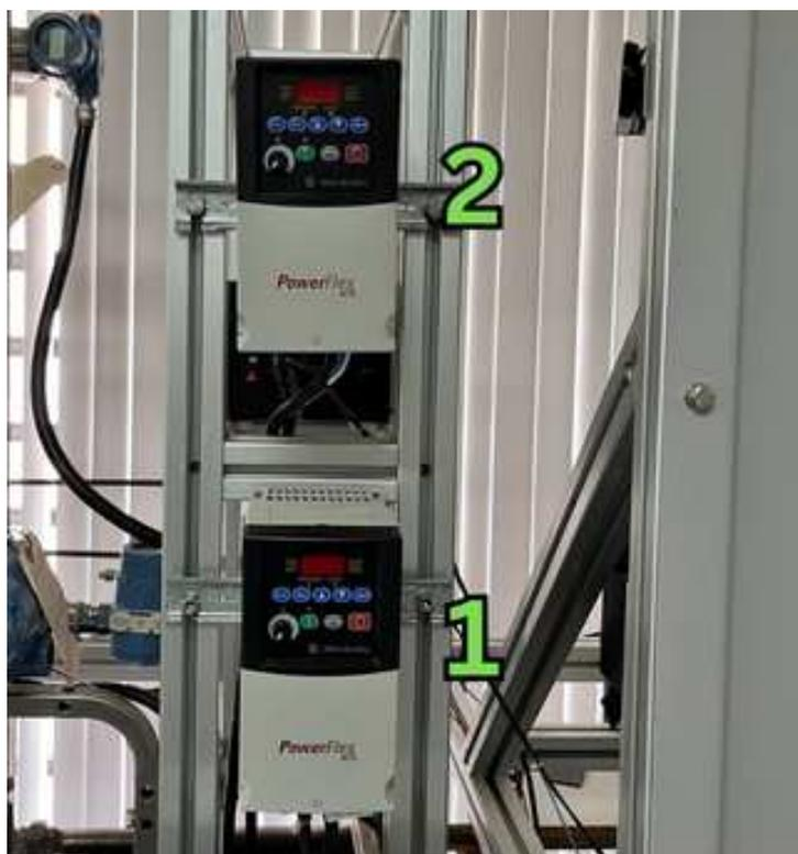
Figura 7 – Inversores de Frequência da Planta
