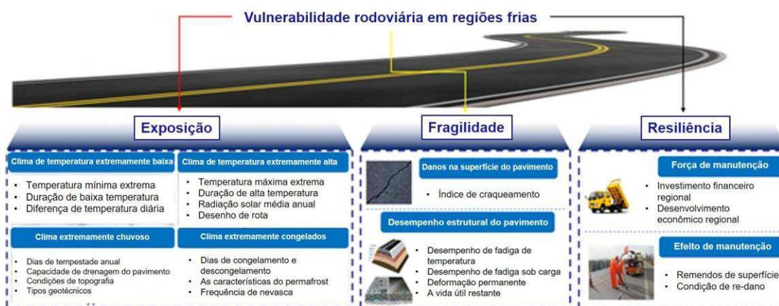
Figura 6. Sistema de índice de avaliação de vulnerabilidade rodoviária em regiões frias. Fonte: Adaptado de Wang et al. (2021).
