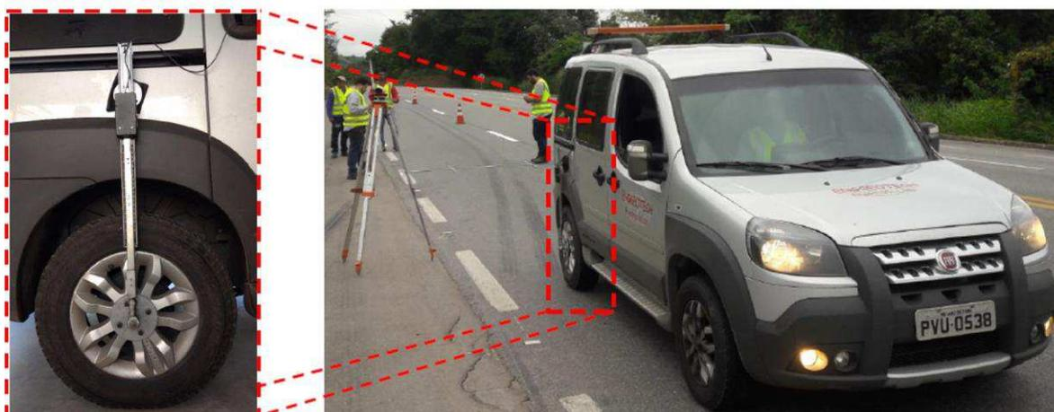
Figura 18. Sistema medidor do tipo resposta SMITR instalado no veículo. Fonte: Adaptado de ANTT (2017).
