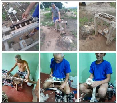
Fotografia 11 – Processo de acabamento (empunhação e caré)
