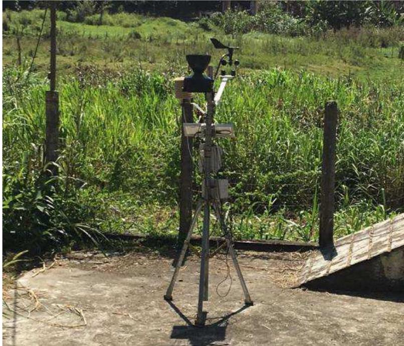
**Fonte:** Arquivo pessoal. Estação meteorológica experimental móvel utilizada neste experimento.
