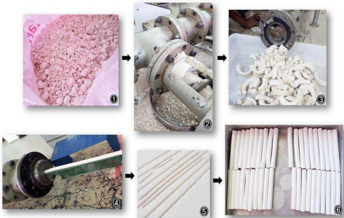
Figura 10 — Processo de conformação das membranas cerâmicas. (1) Mistura contendo pó, aditivo e água nas quantidades adequadas; (2) Homogeneização feita na extrusora aberta; (3) Material resultante da homogeneização; (4) Extrusão de tubos; (5) Tubos prontos para corte; (6) Tubos cortados prontos para secagem.
