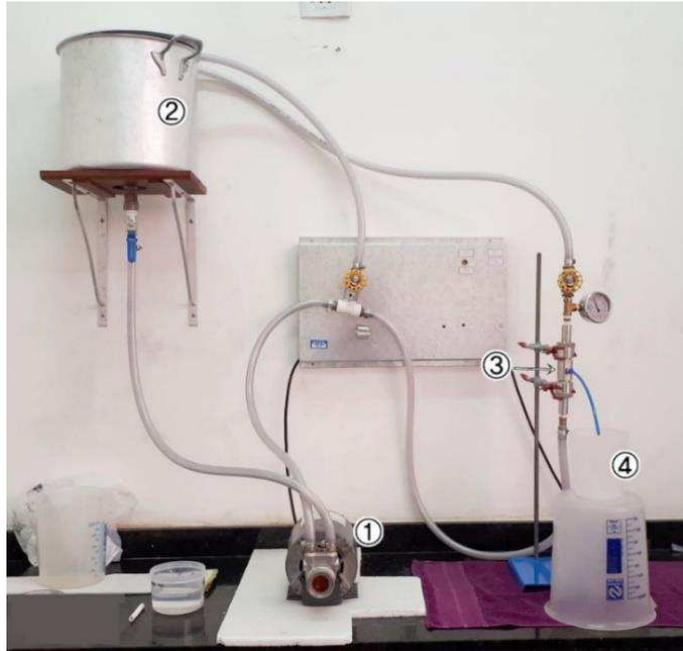
Figura 12 — Sistema de fluxo com escoamento tangencial. (1) Bomba Centrífuga, (2) Reservatório, (3) Reator com a membrana e (4) Reservatório para coleta de permeado.
