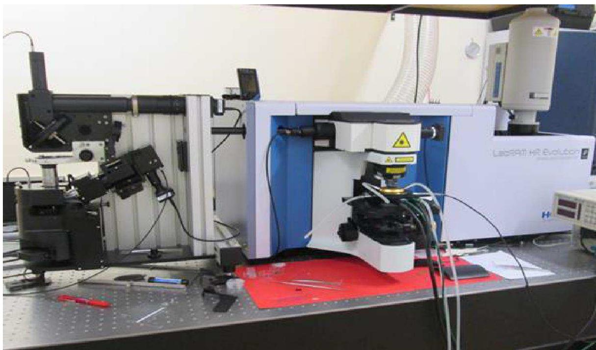
Figura 16 - Espectrômetro micro-Raman HR800 Evolution. Fonte: [17].
