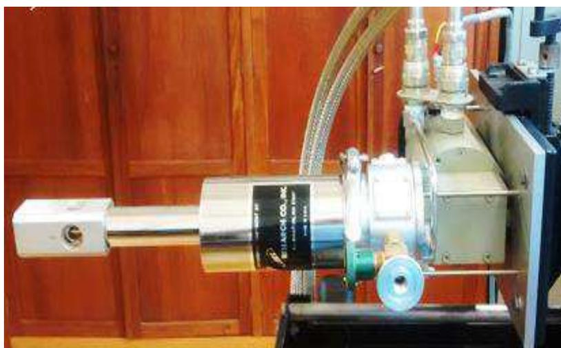
Figura 18 - Criostato com clipe fechado a hélio - Figura adaptada de [17].
