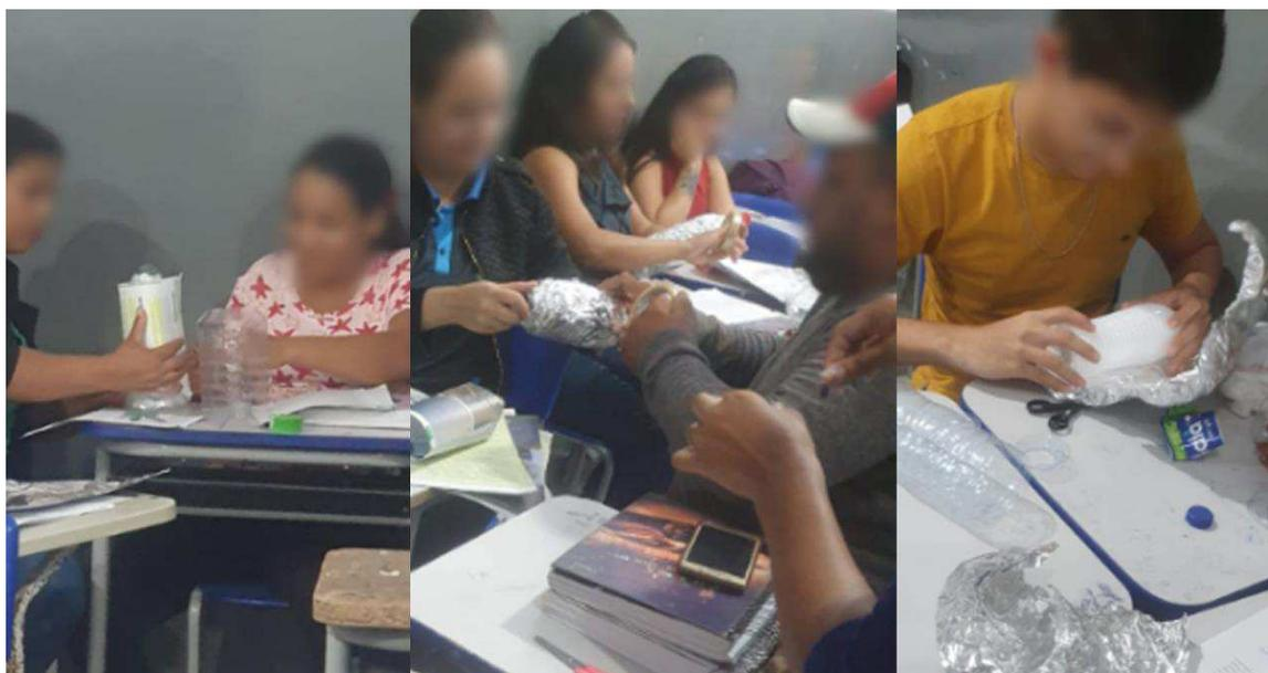
Para avaliar a eficiência das garrafas, é necessário realizar uma comparação com uma referência ou uma medição direta de temperatura em função do tempo. Foi sugerido aos alunos que, em casa, fizessem a comparação do desempenho da garrafa construída com uma garrafa pet convencional como referência. Além disso, enfatizou-se a importância de utilizar água gelada, considerando que as garrafas são feitas de
