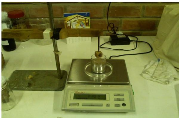
**Figura 1.** Determinações do volume e massa dos corpos-de-prova.
